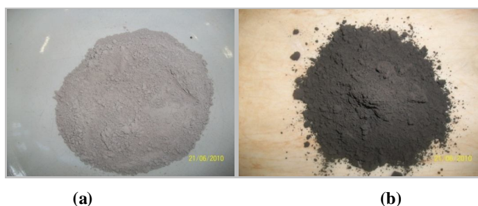
FIGURA 1 – ADIÇÕES MINERAIS UTILIZADAS (A) METACAULIM E (B) CINZA DE BIOMASSA DA CANA-DE-AÇÚCAR.
