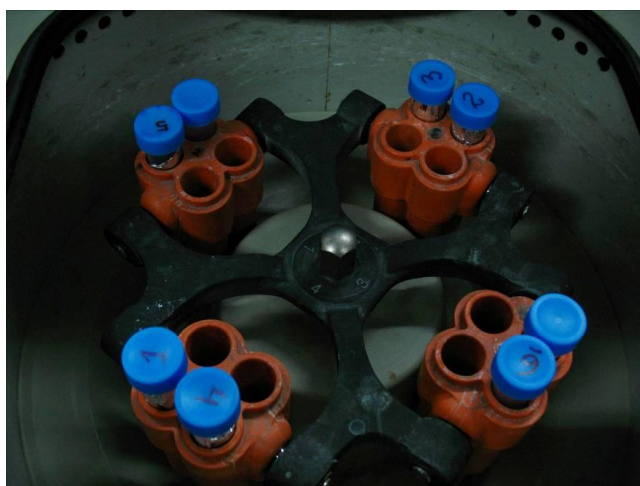
Figura 02: Utilização dos tubos de centrífuga de 15 mL ao invés dos tubos de 50 mL.
