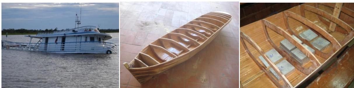
Figura 4a – Barco protótipo. Figura 4b – Barco modelo, escala 1:25. Figura 4c – Calibração do CG do barco modelo.
