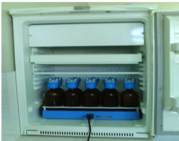
Figura 4: Determinador de DBO 5 e Estufa Incubadora.
