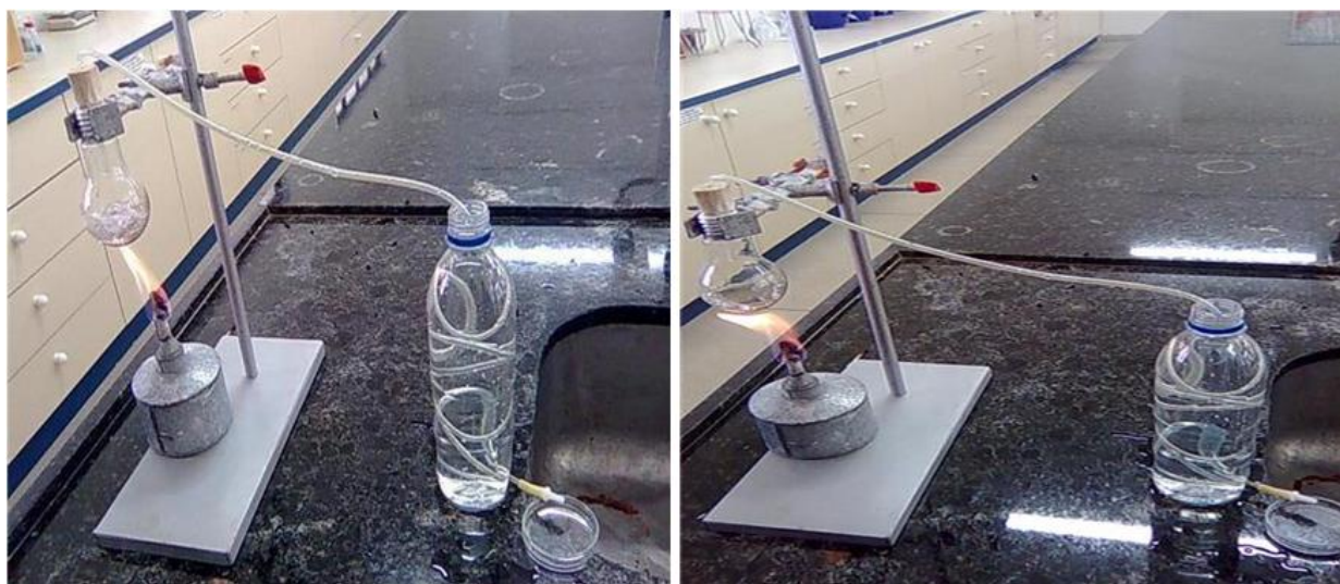
Figura 2 – funcionamento do aparelho de destilação
